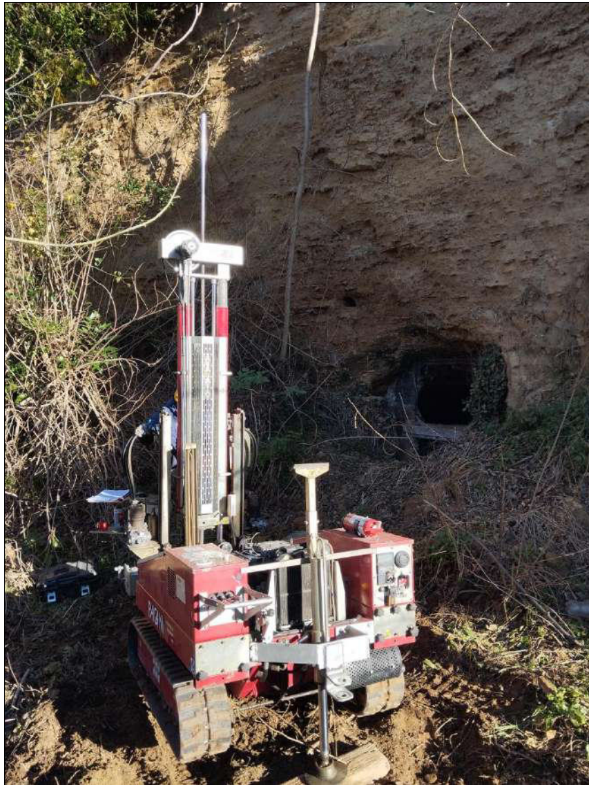
Figura 16 - Postazione prova penetrometrica DPSH_01.
