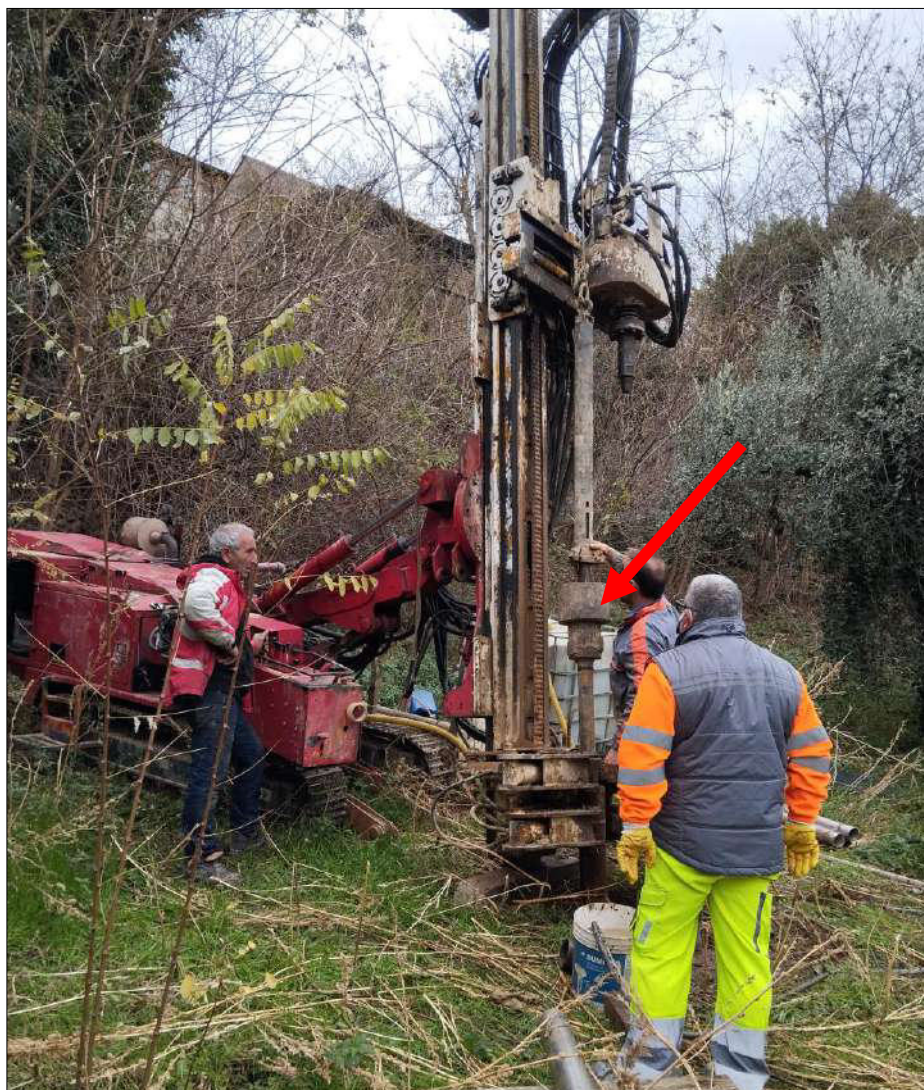
Figura 6 - Esecuzione prova S.P.T.
