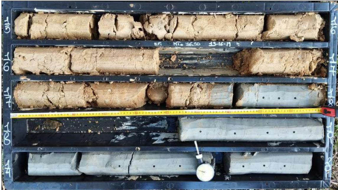
Figura 63 - Foto cassetta catalogatrice n. 04 da 15,00 a 20,00 metri, sondaggio S_01, passaggio stratigrafico alla formazione di base.
