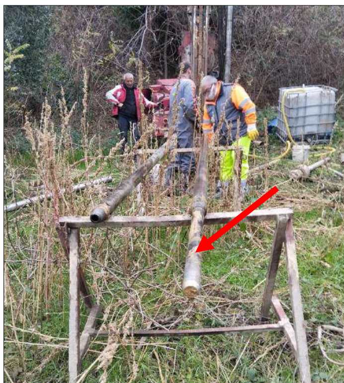
Figura 12 - Campionatore utilizzato a punta aperta.
