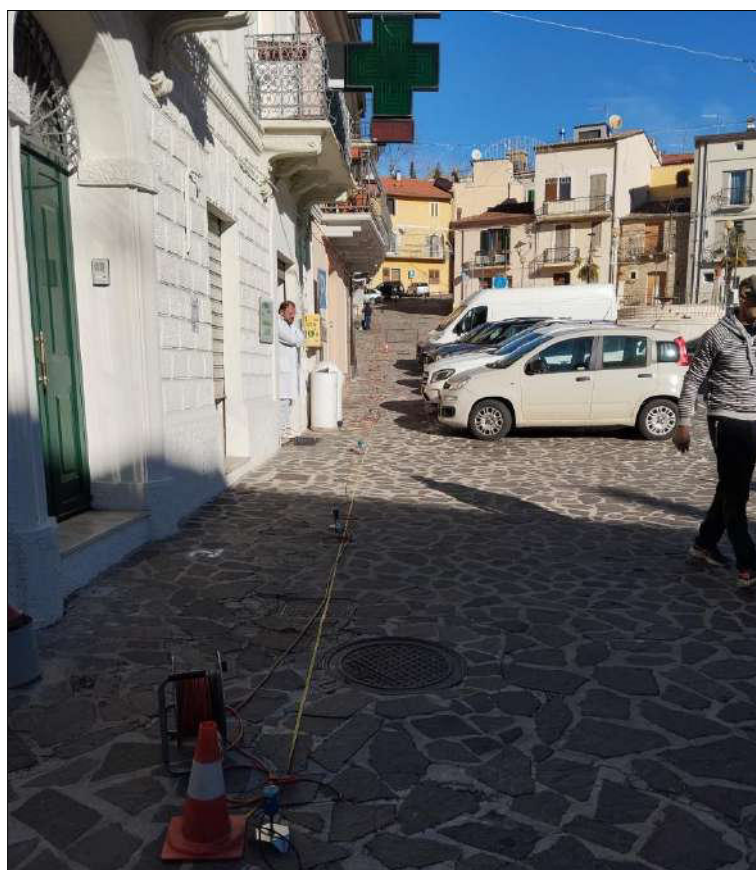
Figura 20 - Postazione prova sismica attiva di superficie M.A.S.W. _01 e Sismica a rifrazione S.R. _01.
