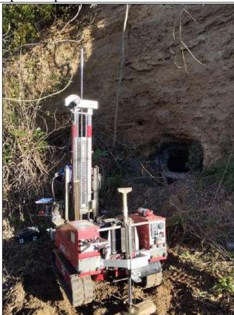
Figura 8 - Foto impianto postazione DPSH_01.
