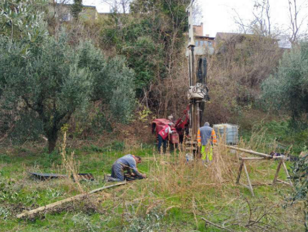
Sondaggio geognostico a carotaggio continuo S_01 e prova S.P.T. in foro di sondaggio
