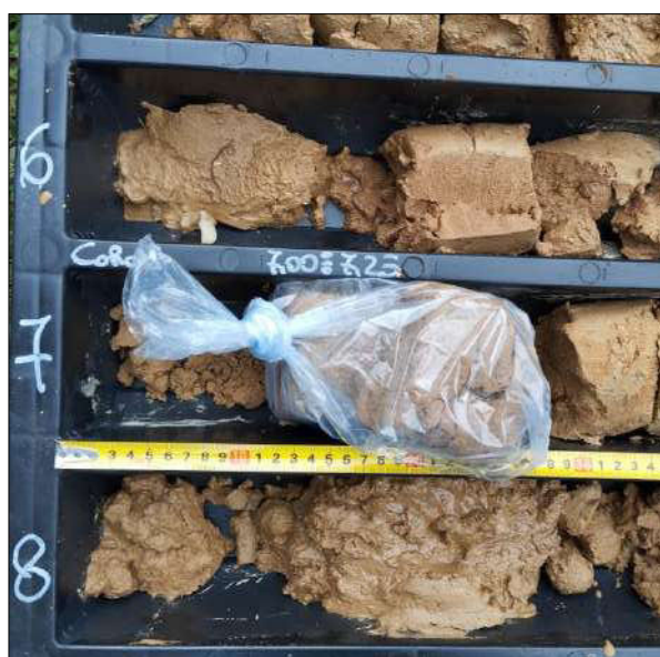
Figura 14 - Campione rimaneggiato verticale indagine S_01.
