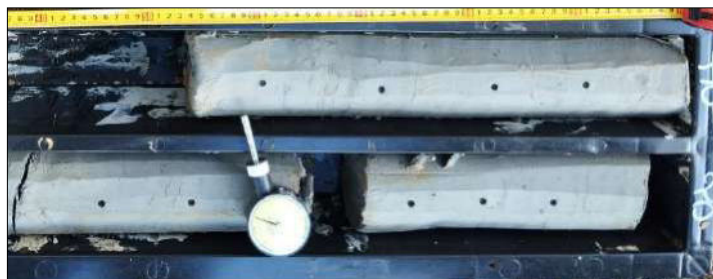
Figura 7 - Prove di consistenza mediante Pocket Penetrometer.
