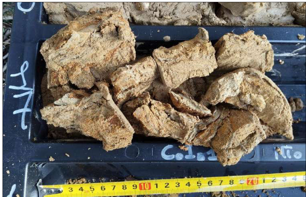
Figura 62 - Particolare intercalazioni limoso argillose alle quote - 12,00 e -17,00 metri dal p.c.
