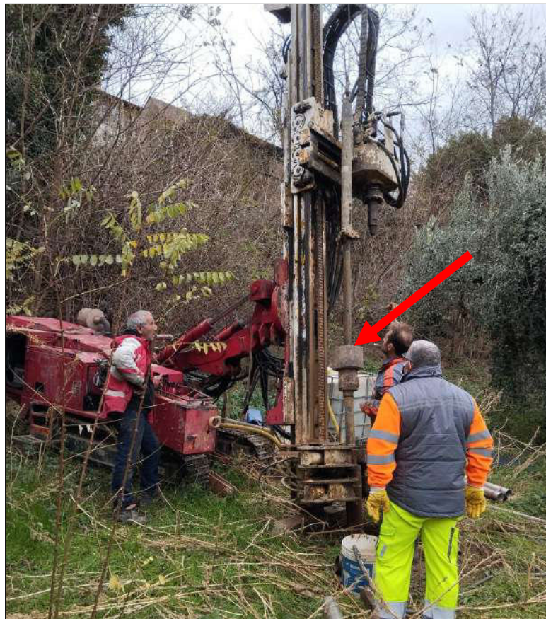
Figura 10 - Esecuzione prova S.P.T.
