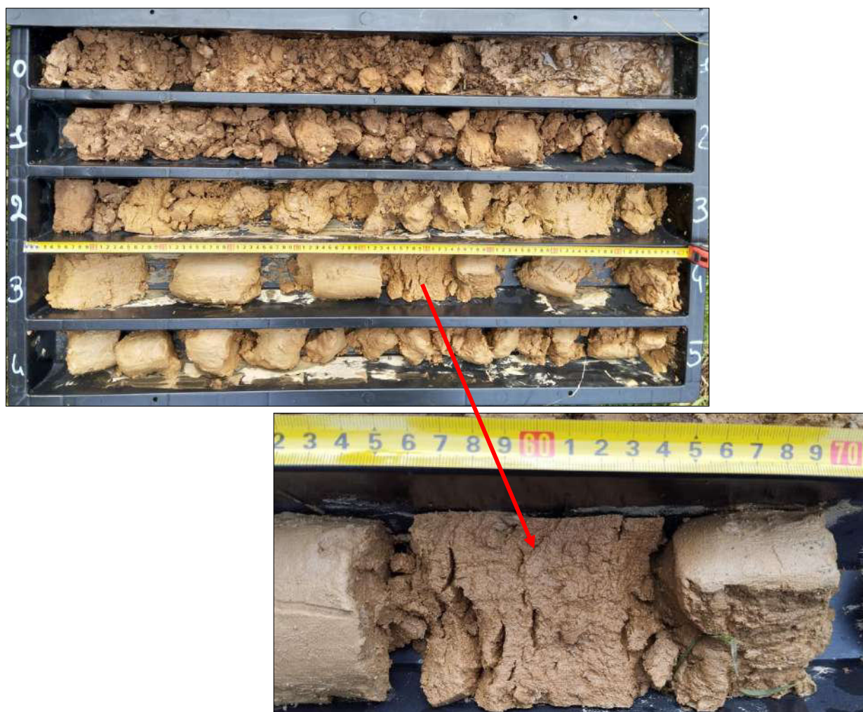
Figura 59 - Foto cassetta catalogatrice n. 01 da 0,00 a 5,00 metri, sondaggio S_01 e particolare carota estratta alla quota - 3,60 metri dal p.c.
