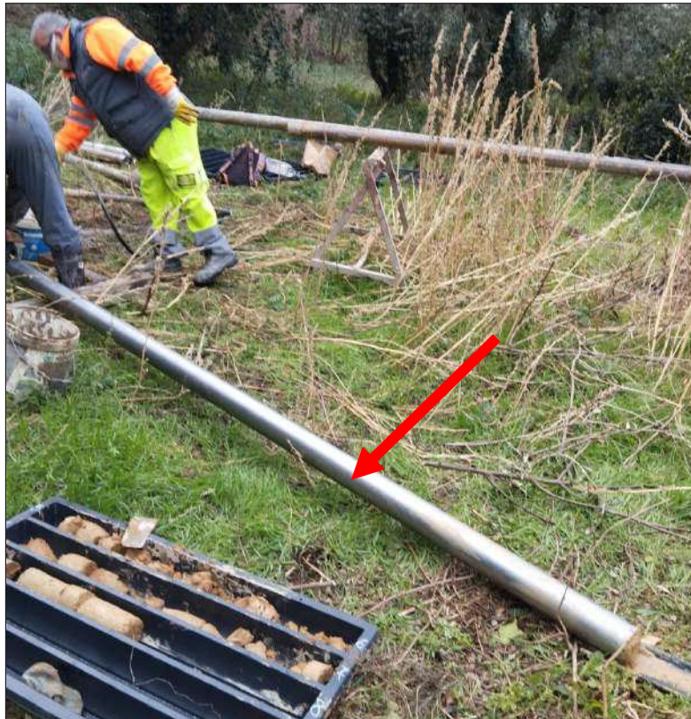
Figura 4 - Carotiere semplice impiegato nella perforazione.
