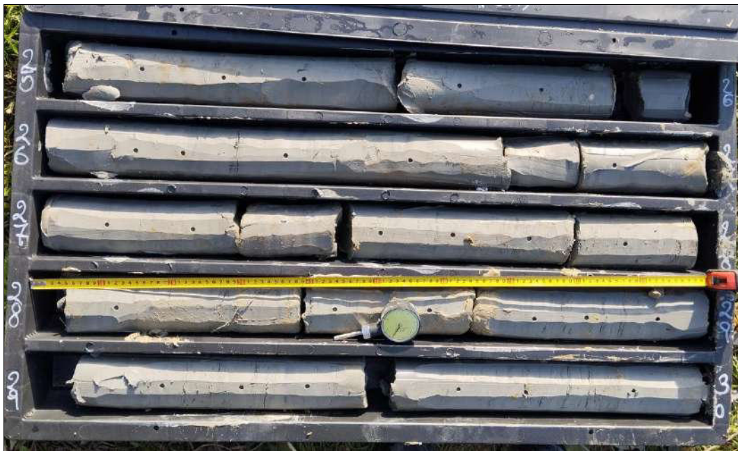
Figura 64 - Foto cassetta catalogatrice n. 06 da 25,00 a 30,00 metri, sondaggio S_01, formazione di base.
