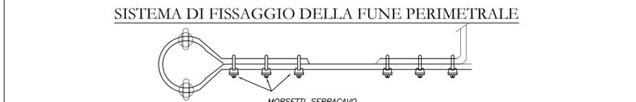
**SISTEMA DI FISSAGGIO DELLA FUNE PERIMETRALE**
